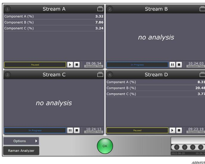
図 61. プローブ 1 とプローブ 4 でモデルをアクティブにした場合の Rxn2 4 チャンネルアナライザの結果
