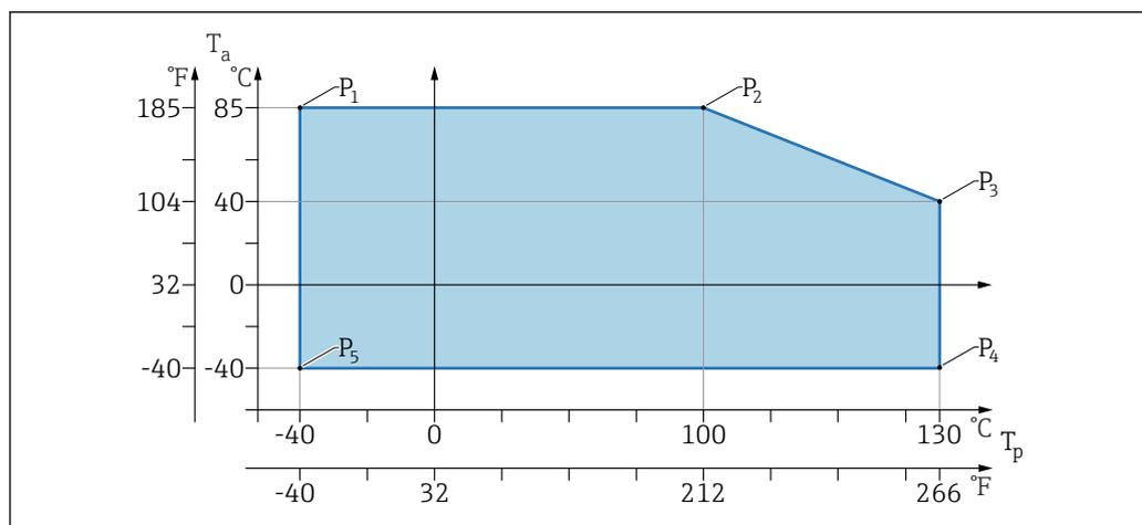
4 Зависимость температуры окружающей среды  $T_a$  от рабочей температуры  $T_p$
