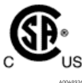
Figure 4. Étiquette CSA pour l'utilisation en zone Ex aux États-Unis et au Canada
