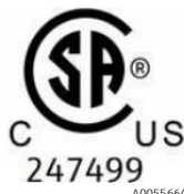
Figure 5. Label indiquant que l'équipement est agréé pour l'utilisation en zone explosible aux États-Unis et au Canada
