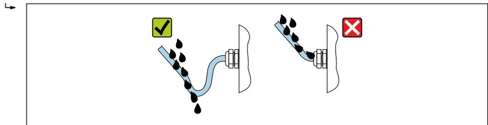
6. Os prensa-cabos fornecidos não garantem a proteção do invólucro quando não estão em uso. Portanto, eles devem ser substituídos por conectores falsos correspondentes à proteção do invólucro.
