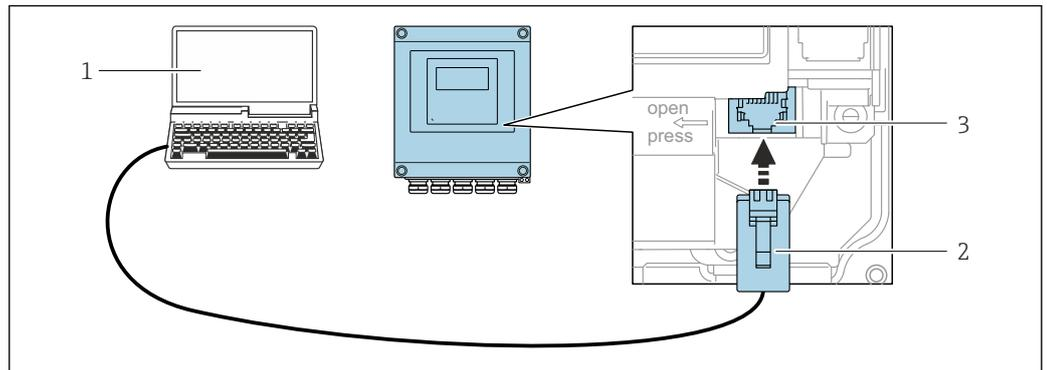
27 Conexão através de Interface de operação (CDI-RJ45)
