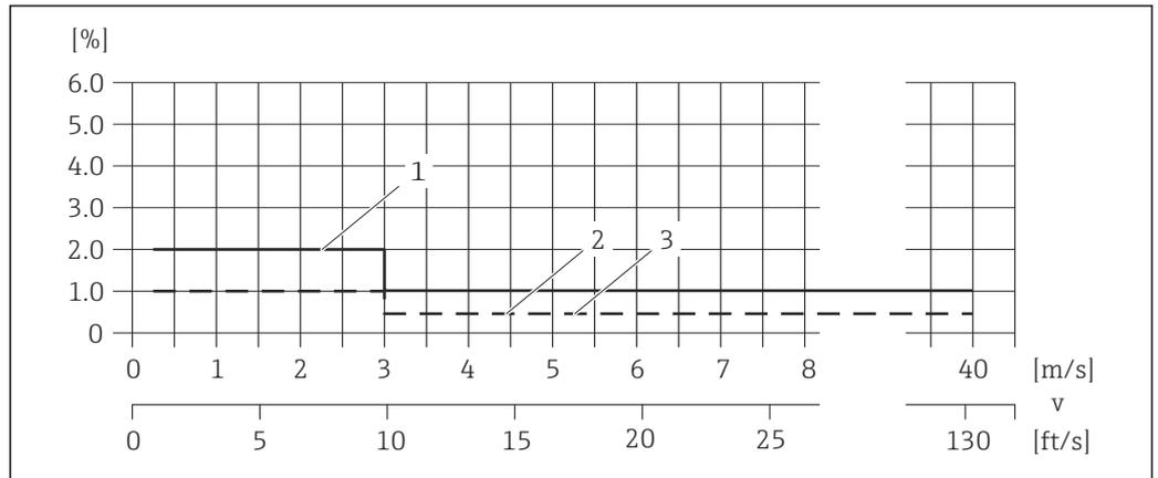
15 Errore di misura massimo (portata volumetrica) in% del valore istantaneo
