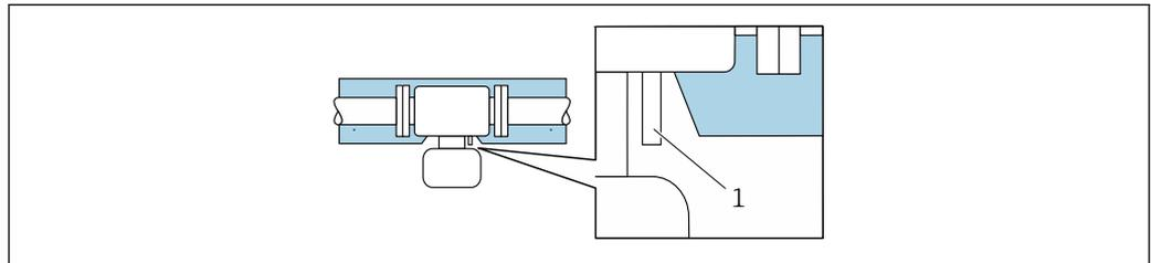
40 Isolation thermique avec tube prolongateur découvert et cellule de mesure de pression
