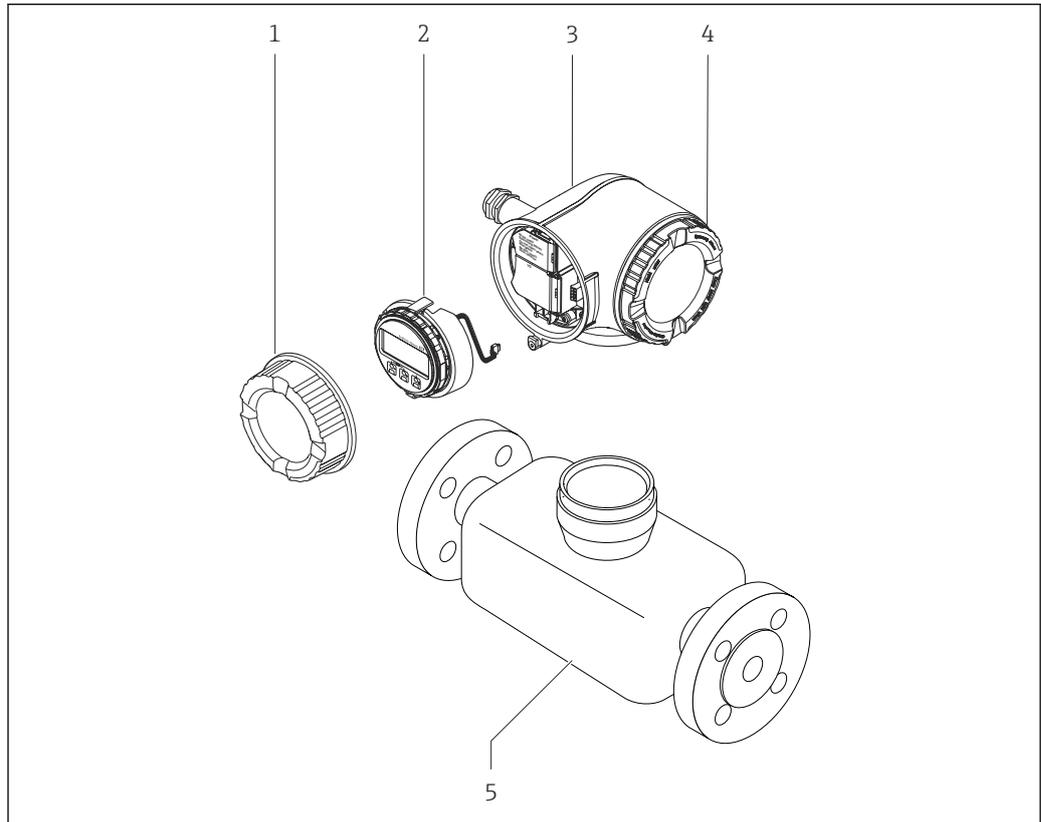
☑ 1 Principaux composants d'un appareil de mesure
