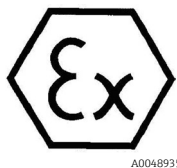
図 6. 危険場所で使用するための ATEX ラベル
