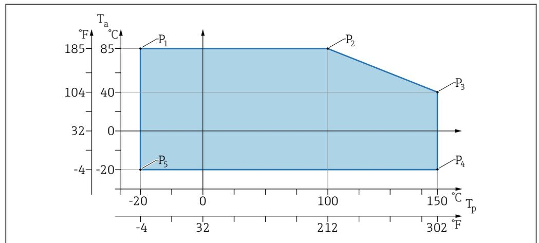
2 Temperatura ambiente T<sub>a</sub> según la temperatura de proceso T<sub>p</sub>
