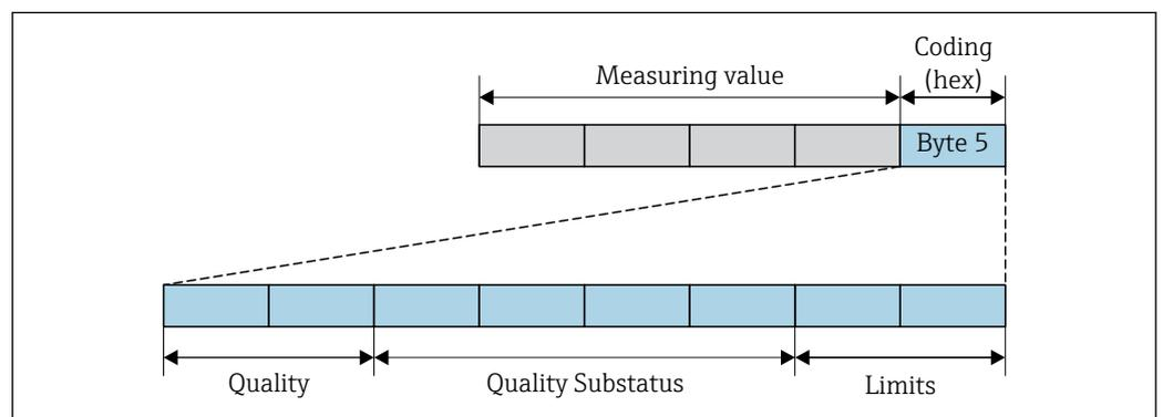
Fig. 21 Estrutura do byte de status
