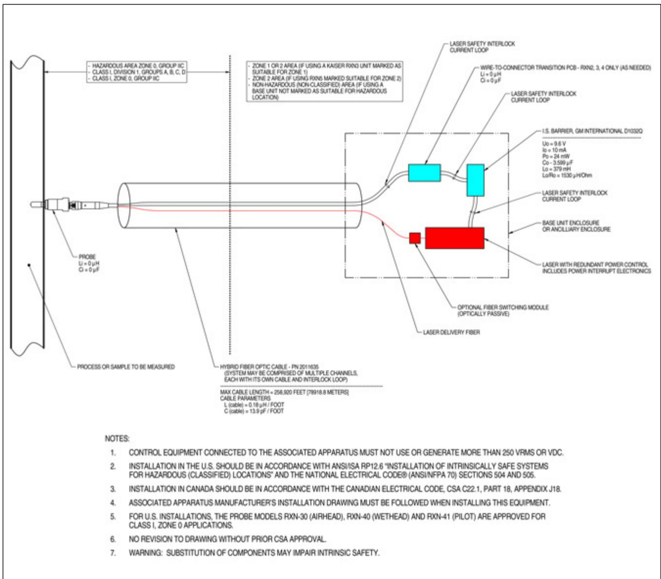
Abbildung 10. Kontrollzeichnung für eigensicheren Sondenschaltkreis (4002396 X6)
