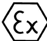
Abbildung 6. ATEX-Kennzeichnung für den Einsatz in explosionsgefährdeten Bereichen
