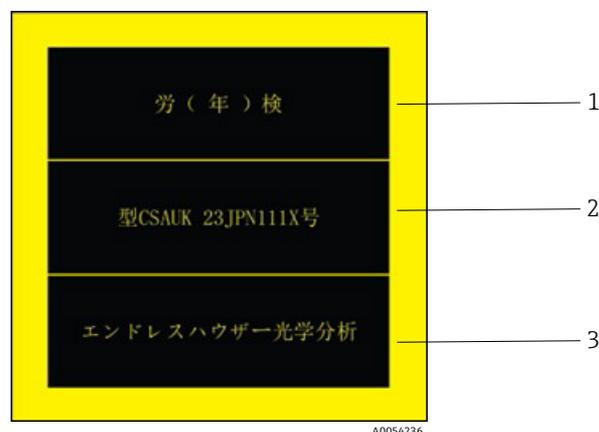
Abbildung 8. JPEX-Kennzeichnung für den Einsatz in explosionsgefährdeten Bereichen
