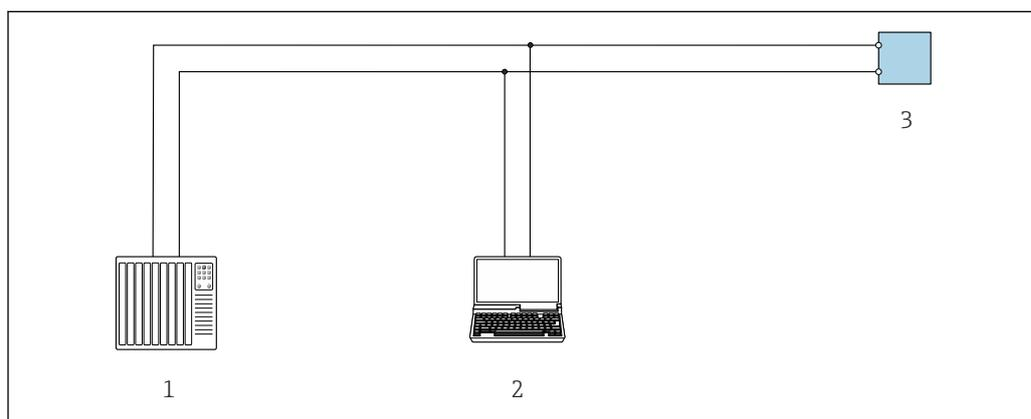
23 Opzioni per funzionamento a distanza mediante protocollo Modbus RS485 (attivo)
