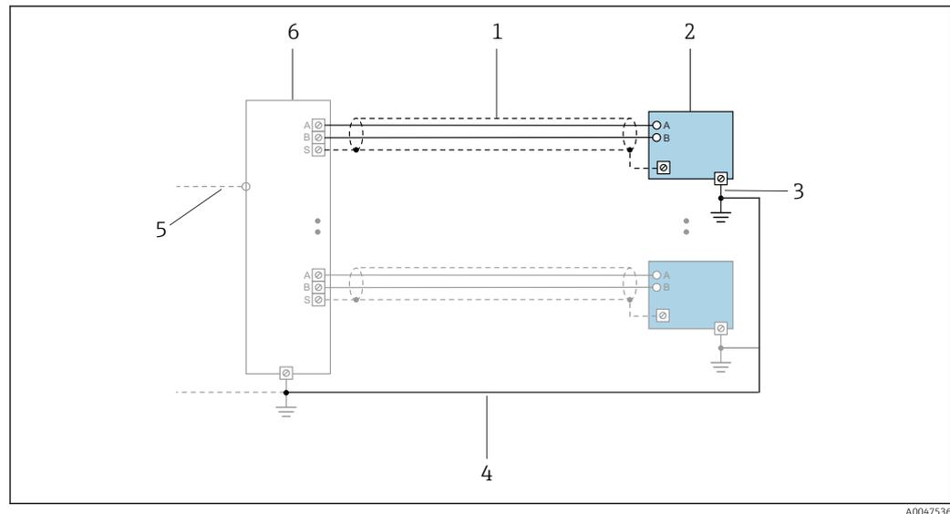
10 Exemple de raccordement pour PROFINET avec Ethernet-APL
