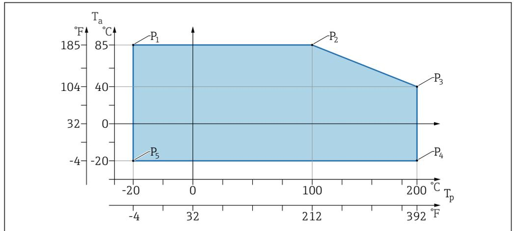
Fig. 3 Temperatura ambiente  $T_a$  según la temperatura de proceso  $T_p$
