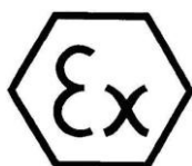
Abbildung 4 ATEX-Etikett für den Einsatz in explosionsgefährdeten Bereichen
