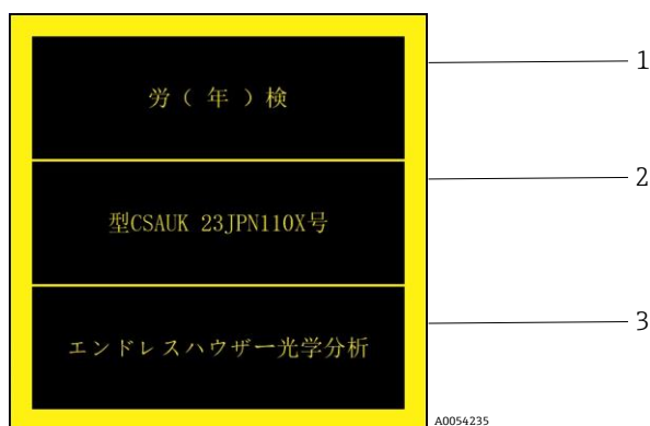
Abbildung 4. JPEX-Etikett für den Einsatz in explosionsgefährdeten Bereichen
