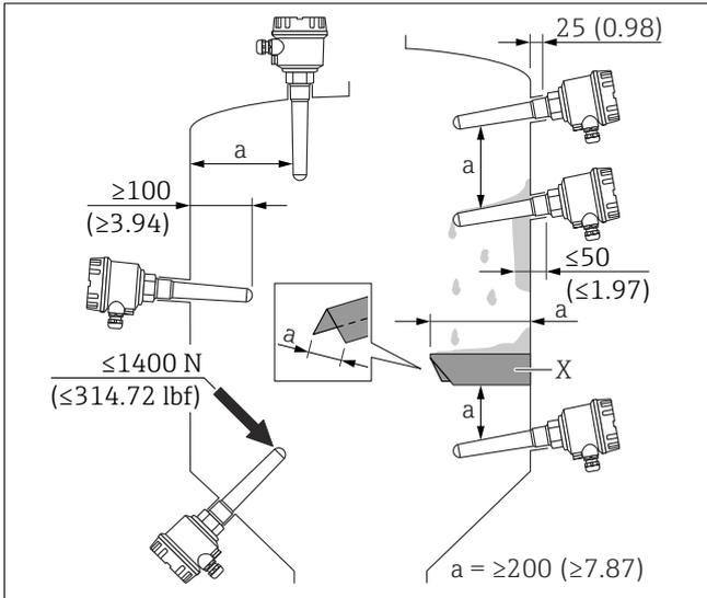
1 Distances minimales pendant le montage dans un silo en mm (inch) ; x : capot de protection
