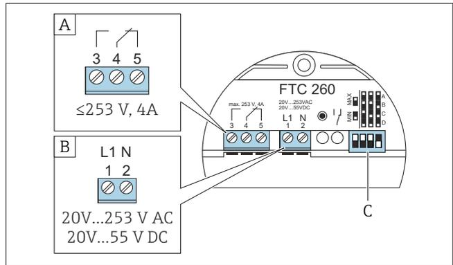
3 Appareil avec raccordement AC ou DC et sortie relais
