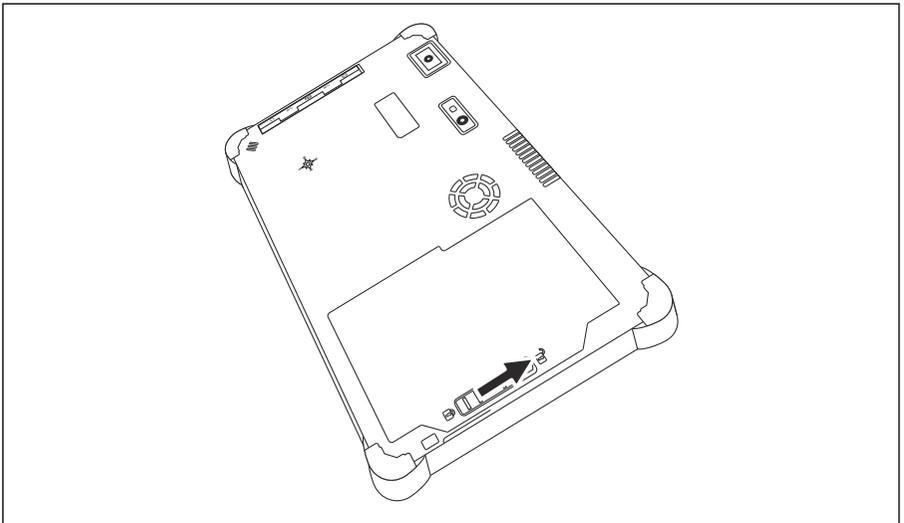
Deslice el bloqueo de batería hacia la posición de "Desbloqueado".
