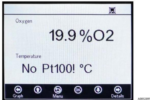
Abbildung 27. Fehlermeldung zum Temperatursensor
