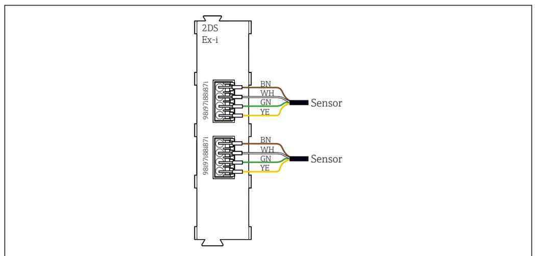
29 Sensori senza tensione di alimentazione addizionale sul modulo di comunicazione sensori tipo 2DS Ex-i
