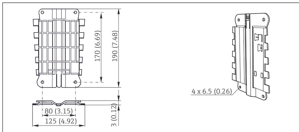
30 Piastra di montaggio. Unità ingegneristica: mm (in)
