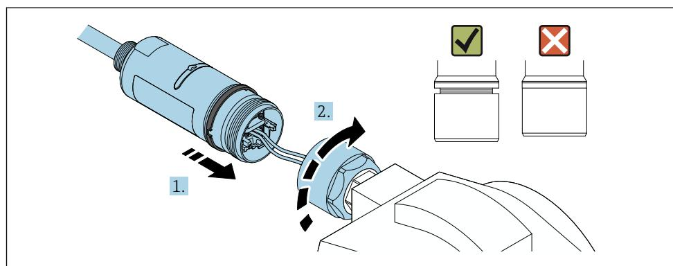
Ainda não aperte a seção superior do invólucro, de forma que ainda seja possível rotacionar a seção inferior do invólucro.
