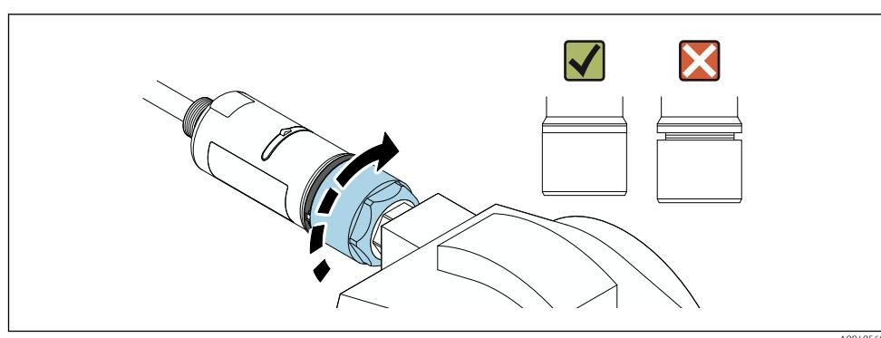
Aperte a seção superior do invólucro de forma que o anel azul do projeto ainda possa ser girado. Torque:  $5 \text{ Nm} \pm 0,05 \text{ Nm}$
