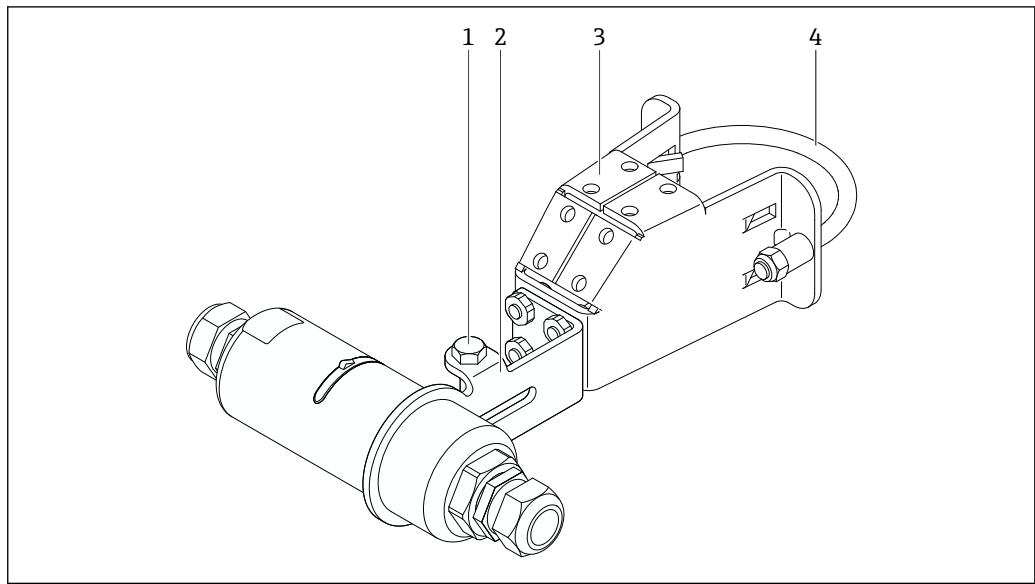
8 FieldPort SWA50 instalado através do suporte de montagem opcional
