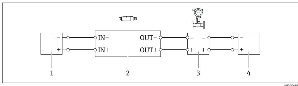
■ 12 Conexão elétrica para equipamentos de campo HART de 4 fios com saída em corrente passiva (aterramento opcional não exibido)
