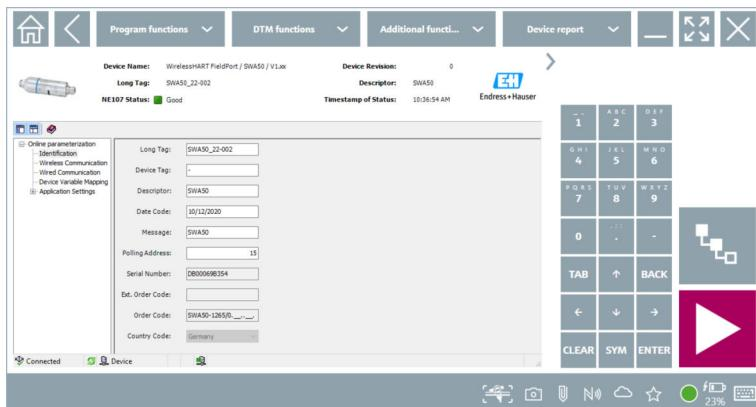
Use o ícone para abrir o DTM do equipamento de campo HART conectado.
