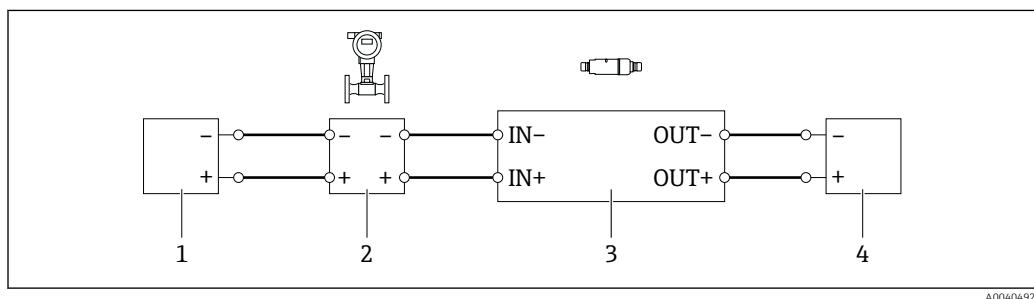
■ 13 Conexão elétrica para equipamentos de campo HART de 4 fios com saída em corrente ativa (aterramento opcional não exibido) - CLP ou transmissor nos terminais OUT
