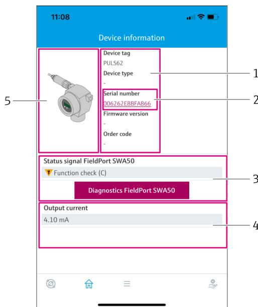
Fig. 22 Visualização "Device information" – exemplo para o SWA50 com o equipamento de campo HART de outro fabricante
