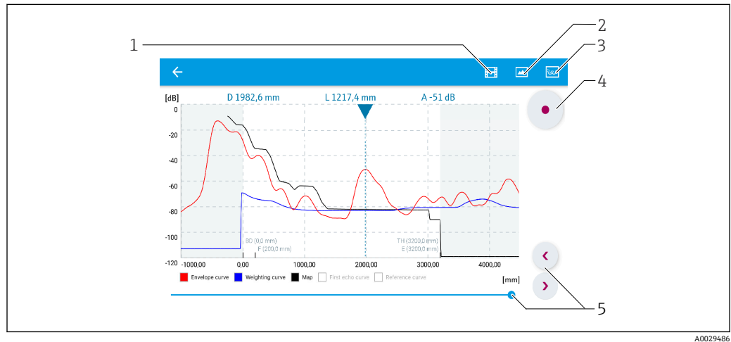
图 30 实例：Android 设备使用 SmartBlue 显示包络线
