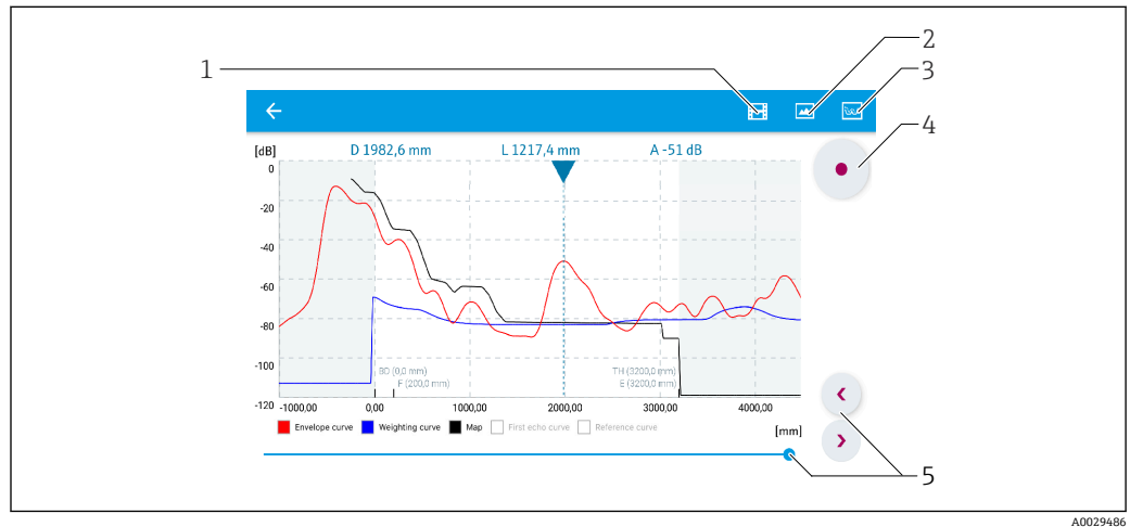
图 35 实例：Android 设备使用 SmartBlue 显示包络线
