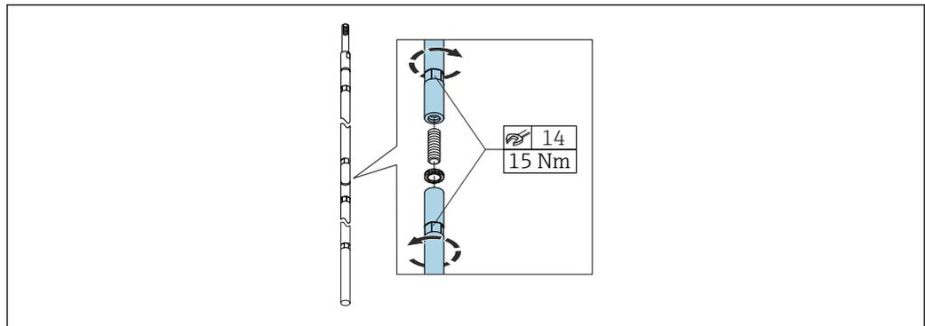
En condiciones de montaje confinado (espacio respecto al techo), es aconsejable el uso de una sonda de varilla separable (Ø 16 mm).
