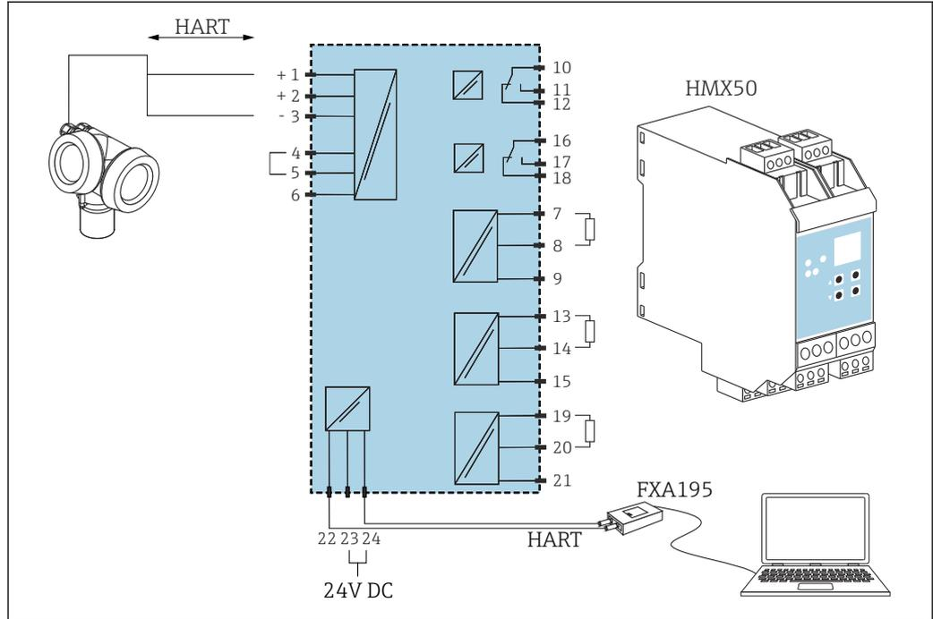
24 Diagrama de conexión del convertidor de lazo HART HMX50 (ejemplo: instrumento pasivo a 2 hilos y salidas de corriente conectados como fuentes de alimentación)
