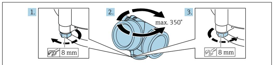
1. Use una llave fija para desenroscar el tornillo de fijación.
