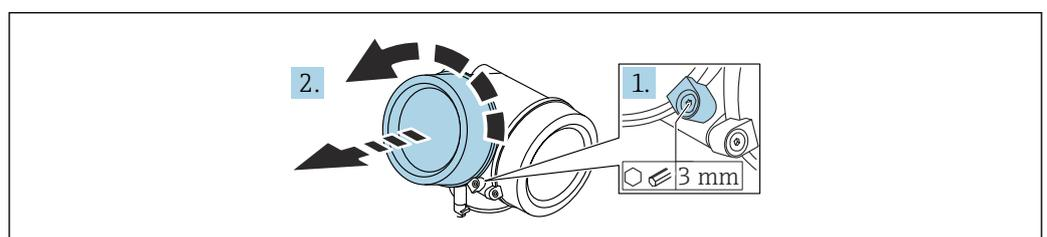
1. Afloje el tornillo de bloqueo de la tapa del compartimento de la electrónica mediante una llave Allen (3 mm) y gire la lengüeta 90 ° en el sentido de las agujas del reloj.
