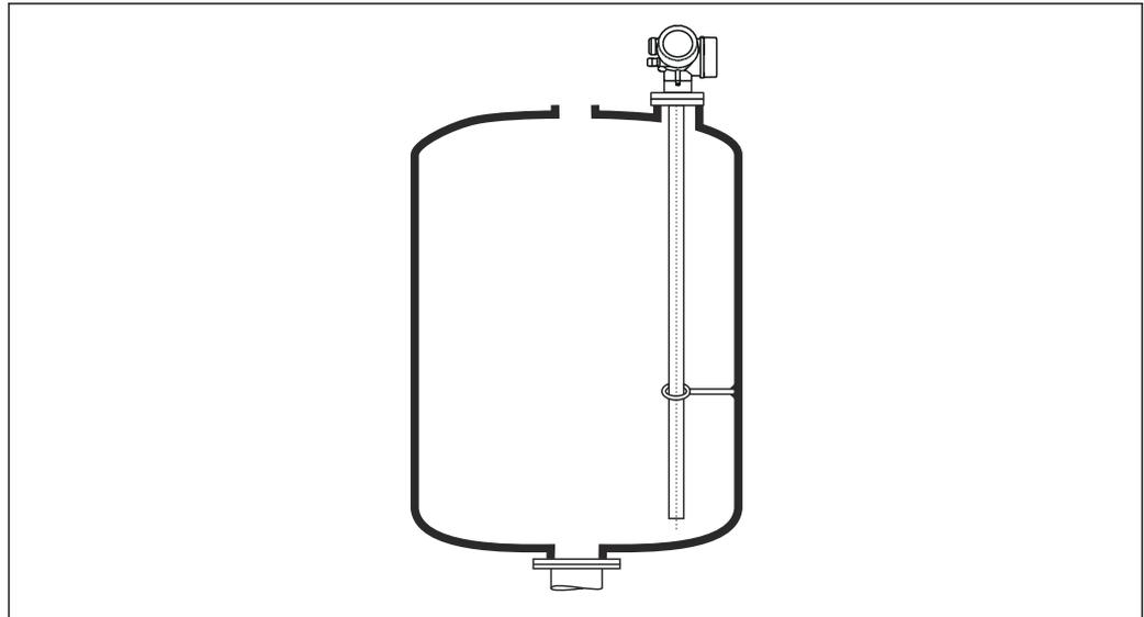
Las sondas coaxiales se pueden asegurar (fijar) en cualquier punto del tubo de puesta a tierra.
