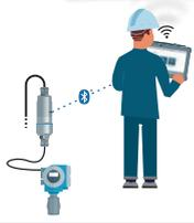
エンドレスハウザーおよび他社製のフィールド機器を、無線または有線接続によるデジタル通信インターフェースで管理でき、立ち上げ時や保全管理者のIoT対応ツールに最適です。
