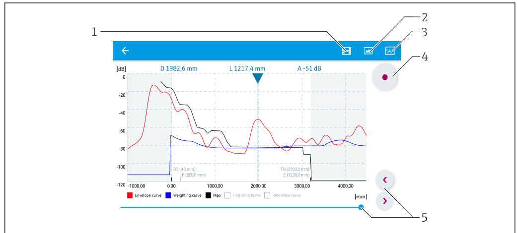
図 31 SmartBlue (Android 版) での反射波形表示 (例)
