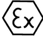
Figura 4 Etiqueta ATEX para uso en áreas de peligro
