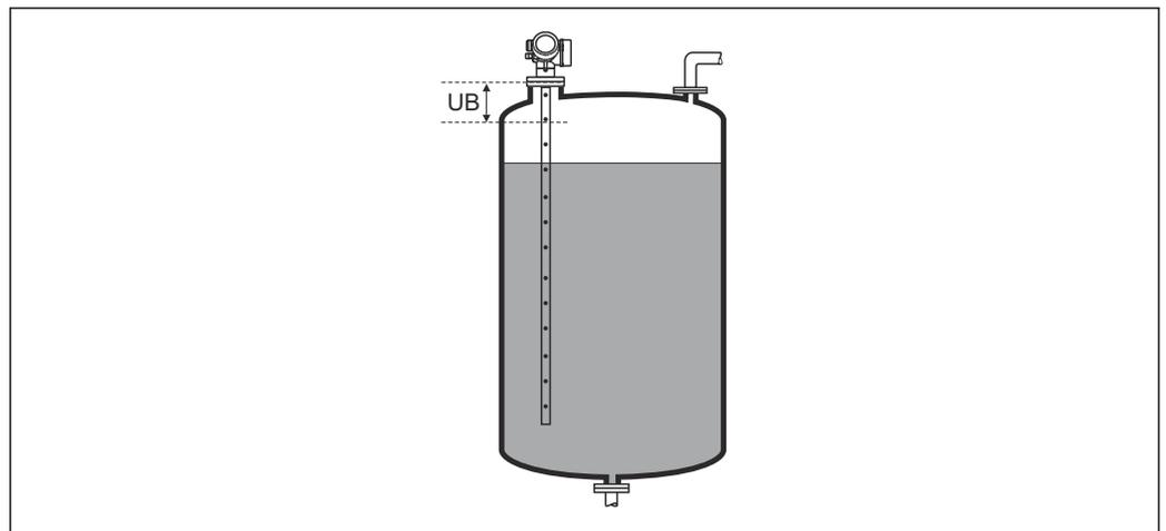
**49** Distanza di blocco (UB) per misure di liquidi
