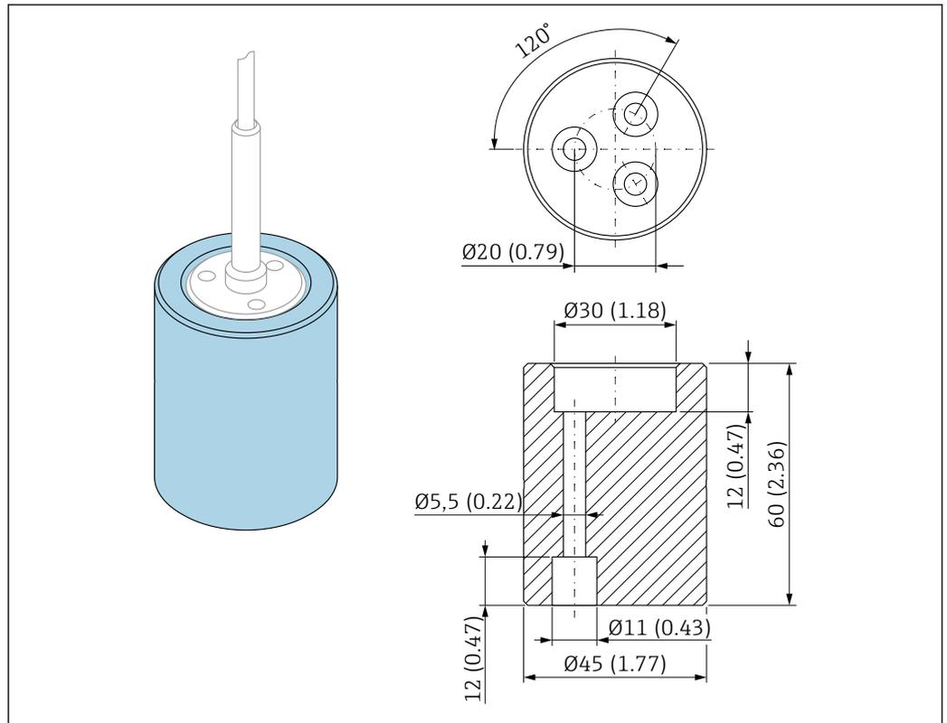
Il peso di centraggio è adatto a sonde con diametro della fune di 4 mm ( $\frac{1}{8}$  in) e può essere utilizzato in tubazioni DN50/2".
