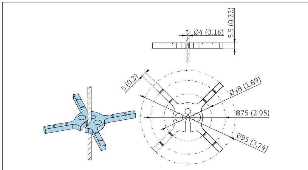
La rosetta di centraggio è adatta a sonde con diametro della fune di 4 mm ( $\frac{1}{8}$  in) (anche sonde a fune rivestite).
