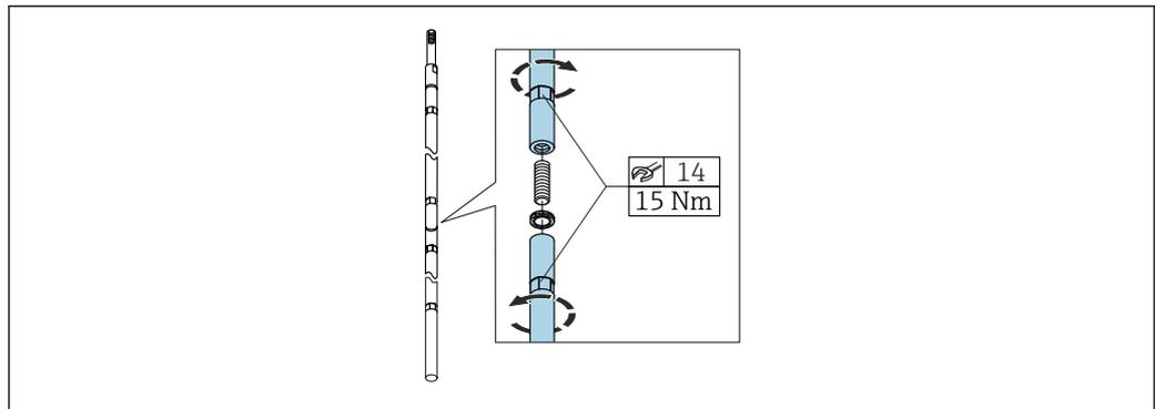
In spazi di montaggio limitati (distanza dal soffitto), è consigliabile utilizzare sonde ad asta separabili (Ø 16 mm).
