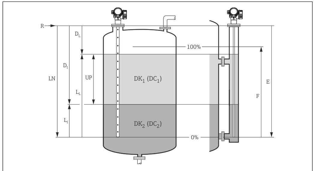
**27** Paramètres de configuration pour la mesure d'interface
