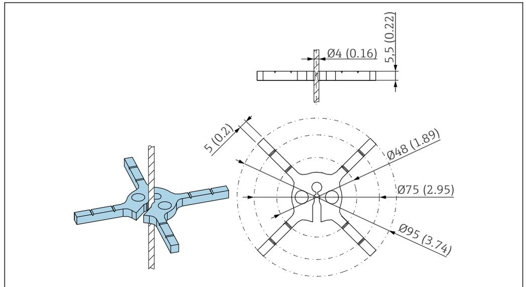
L'étoile de centrage est adaptée aux sondes avec diamètre de câble de 4 mm ( $\frac{1}{8}$  in) (sondes à tige revêtues incluses).
