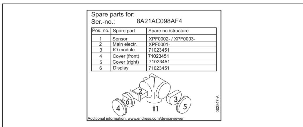
30 Exemple de plaque signalétique des pièces de rechange dans le couvercle du compartiment de raccordement
