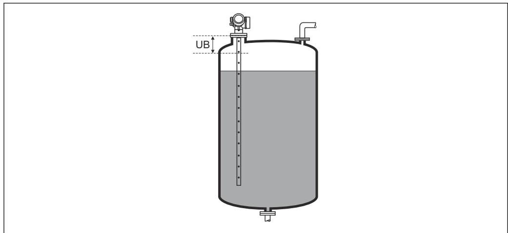
46 Distance de blocage (UB) pour la mesure dans les liquides
