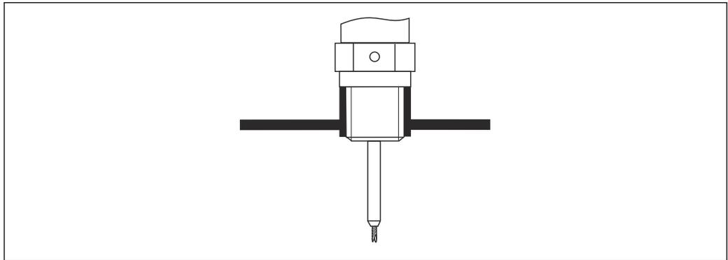
4 Montage avec raccord fileté ; affleurant avec le plafond de la cuve
