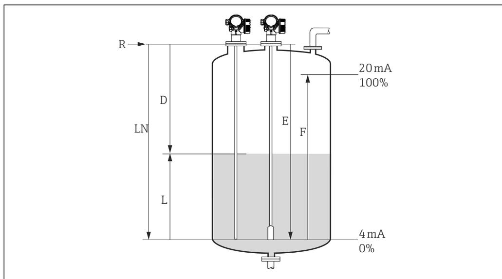
26 Параметры конфигурации для измерения уровня жидкости
