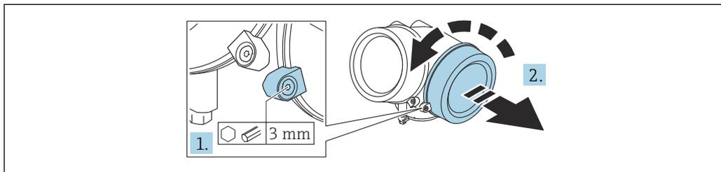
1. Шестигранным ключом (3 мм) ослабьте винт крепежного зажима крышки отсека электроники и поверните зажим 90 град против часовой стрелки.
