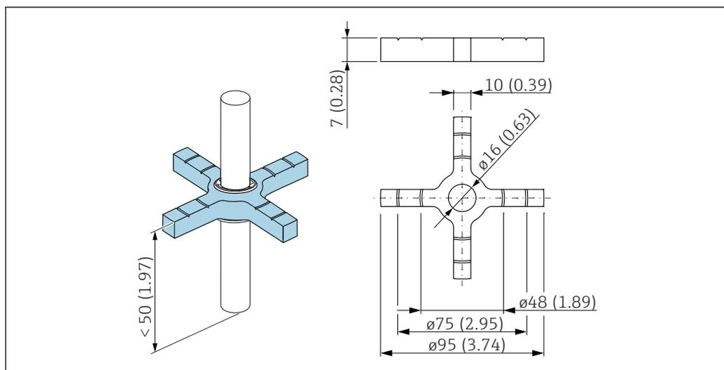
37 Размеры; центрирующая звездочка PEEK  $\varnothing$  48 до 95 мм (1,89 до 3,74 дюйм)
