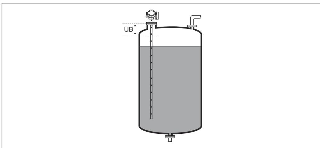
46 Блокирующая дистанция (UB) для измерения в жидких средах
