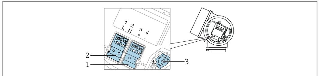
12 Назначение клемм, 4-проводное подключение: 4 до 20 мА HART (90 до 253 В<sub>АС</sub>)
