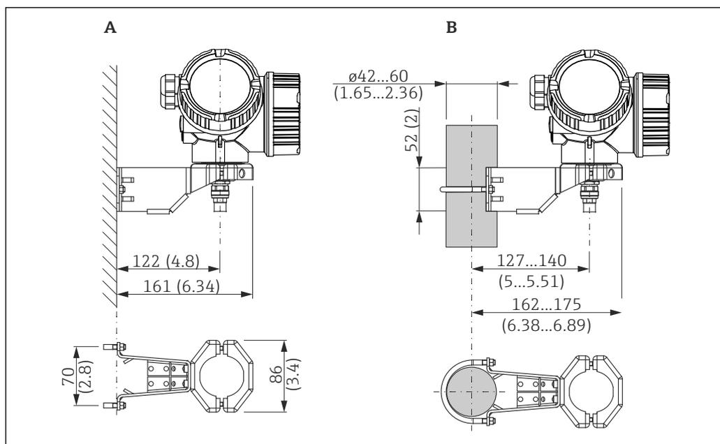
10 Монтаж корпуса блока электроники на монтажном кронштейне. Единица измерения мм (дюйм)
