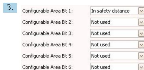
Wählen Sie eines dieser Bits (hier zum Beispiel: **Configurable Area Bit 1**) und wählen Sie aus der zugehörigen Auswahlliste die Option **In safety distance**. Bestätigen Sie diese Auswahl mit der Enter-Taste.
