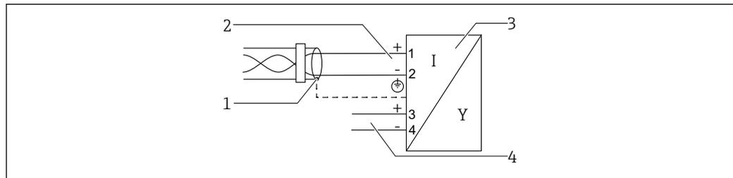
8 Schéma de principe PROFIBUS PA / FOUNDATION Fieldbus
