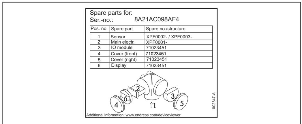
▣ 27 Exemple de plaque signalétique des pièces de rechange dans le couvercle du compartiment de raccordement
