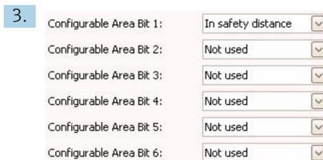
Sélectionner l'un de ces bits (ici par exemple : **Configurable Area Bit 1**) et choisir dans la liste correspondante l'option **Dans distance de sécurité**. Confirmer la sélection en appuyant sur la touche Enter.
