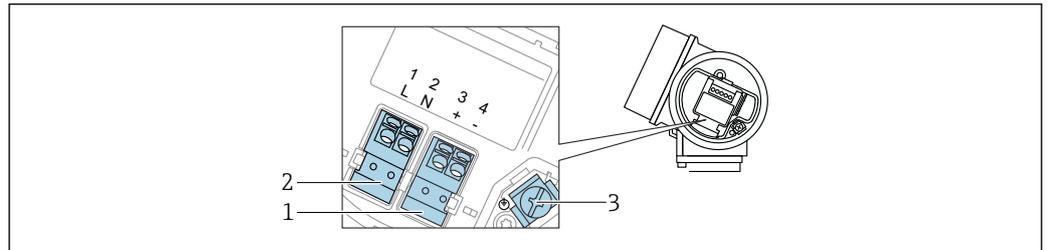
**8** Назначение клемм, 4-проводное подключение: 4 до 20 мА HART (90 до 253 В<sub>АС</sub>)
