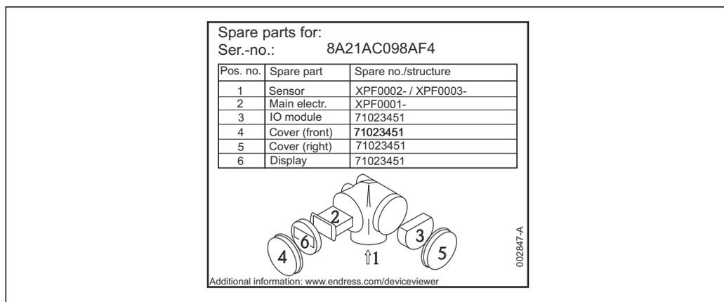
29 Пример заводской таблички с перечнем запасных частей, размещаемой на крышке присоединительного отсека
