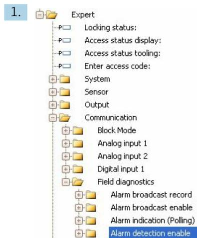
Используйте окно навигации FieldCare для перехода к следующему экрану: **Expert** → **Communication** → **Field diagnostics** → **Alarm detection enable**.
