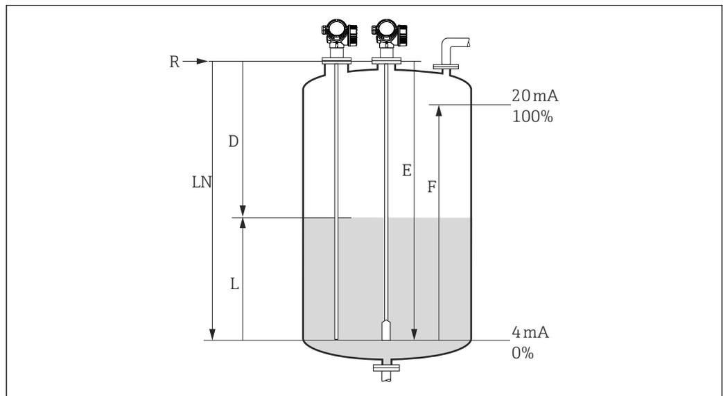
**25** Параметры конфигурации для измерения уровня жидкости
