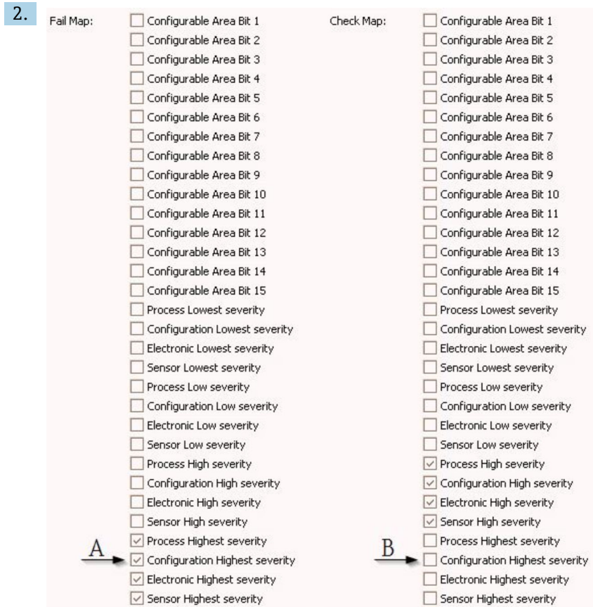
図 31 「故障マップ (Fail Map)」列と「チェックマップ (Check Map)」列のデフォルトの状態
