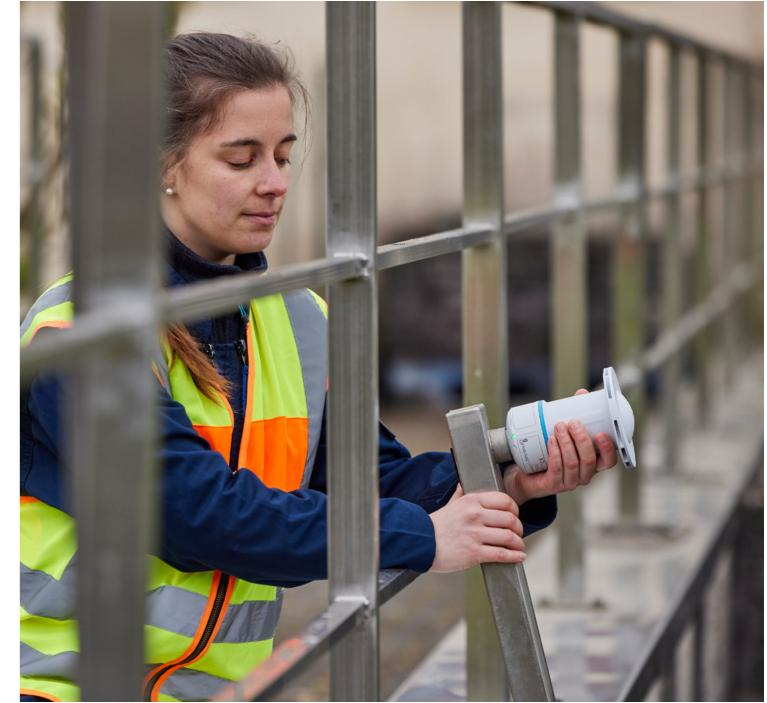
Heartbeat Technology ermöglicht eine dokumentierte, rückführbare und geführte Verifizierung ohne Prozessunterbrechung, jederzeit auf Abruf. Eine Geräteüberprüfung kann in weniger als drei Minuten durchgeführt werden, ohne dass das Gerät ausgebaut werden muss.
