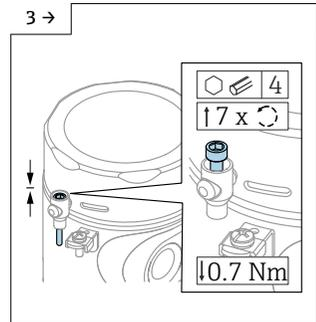
► Optional: Deckelsicherung Einkammergehäuse 316L Hygiene
