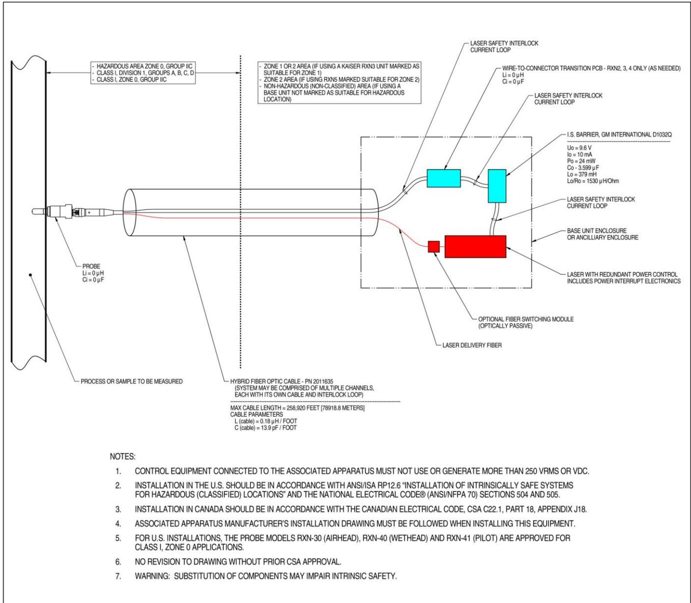
Figura 5. Desenho de instalação do equipamento em áreas classificadas
