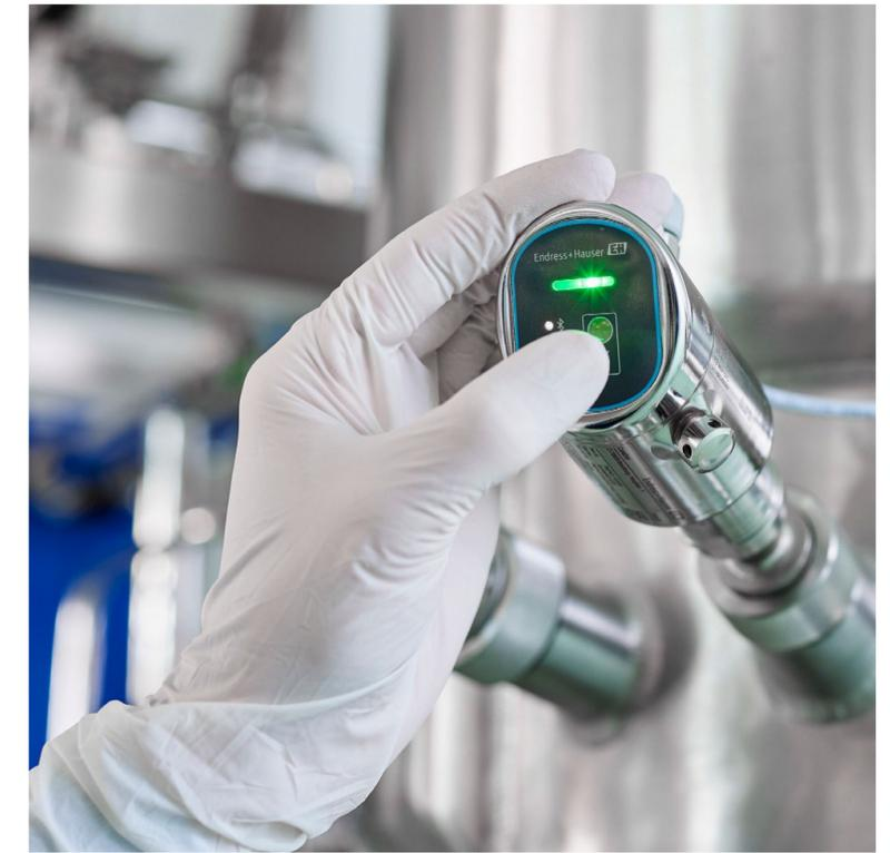
Nell'intransigenza delle applicazioni igieniche, una pulizia sicura ed efficace è essenziale per la sicurezza del prodotto e del processo, l'efficienza e i costi. I misuratori sono realizzati in acciaio inox e possono essere puliti dall'esterno con detergenti e idropulitrici, grazie alla classe di protezione IP69, anche per versioni con display.
