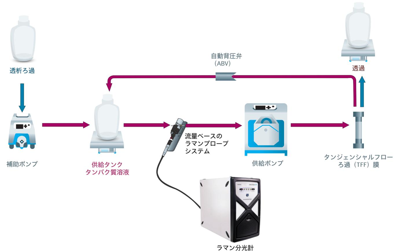
従来のUF/DFシステムは通常、システム圧力、流量、および供給量と透過量の両方を監視する機能を備えています。一方、ラマンプローブが組み込まれたUF/DFシステムでは、モノマーと凝集体レベル、および緩衝添加剤の濃度をインラインで監視することが可能です。
