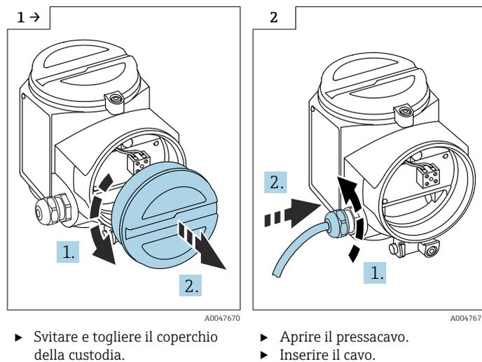
**i** Morsetto a vite per sezioni del conduttore 0,5 ... 2,5 mm.
