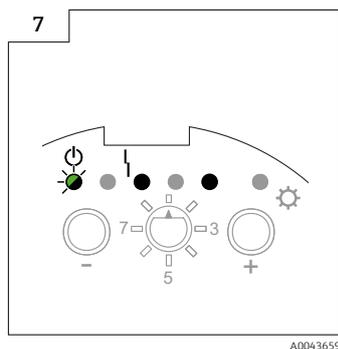
Per impostare la modalità di sicurezza MIN e bloccare la modalità SIL (solo con inserto elettronico FEI55):
