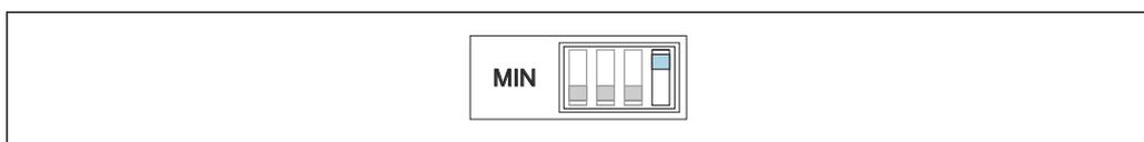
**53** L'uscita commuta orientata alla sicurezza quando la sonda è scoperta. Serve nei casi come la protezione contro il funzionamento a secco e la protezione delle pompe.
