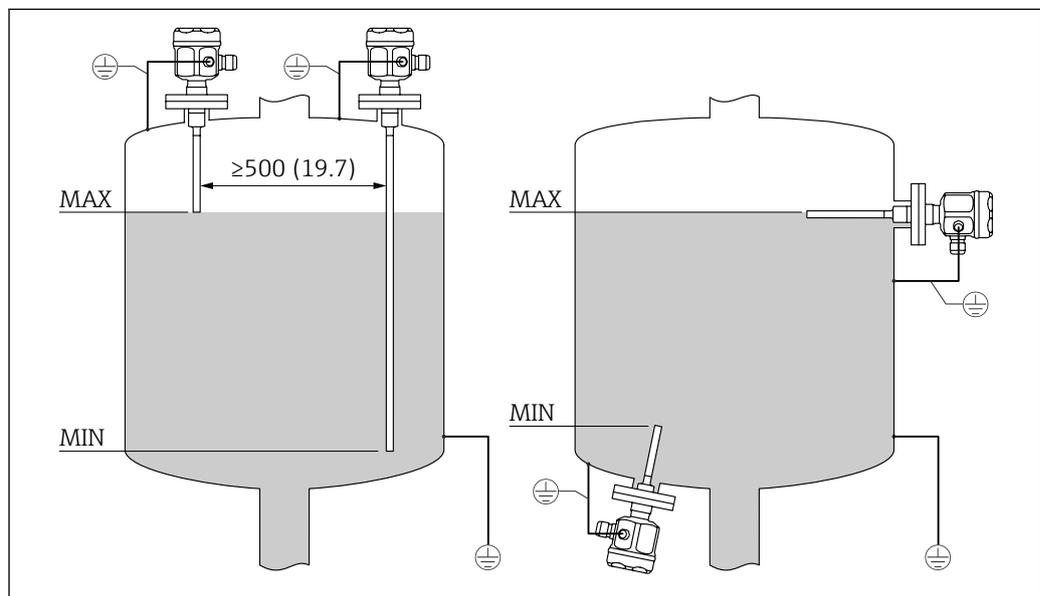
**1** Montaggio del sensore in serbatoi elettricamente conduttori. Unità di misura mm (in)
