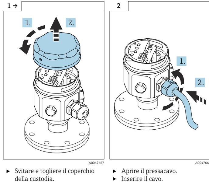
Collegamento dell'inserto elettronico all'alimentazione montato nella custodia T13:
