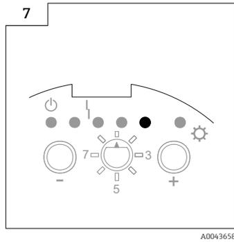
**i** Il blocco in "Modalità blocco SIL" attiva il messaggio di errore all'uscita in corrente ( $I < 3,6 \text{ mA}$ ) ed è segnalato dal LED 4 rosso.
