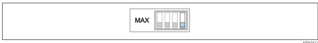
50 Выходной сигнал переключается в режиме безопасности, если зонд покрыт продуктом. Он может использоваться в таких случаях, как защита от переполнения.
