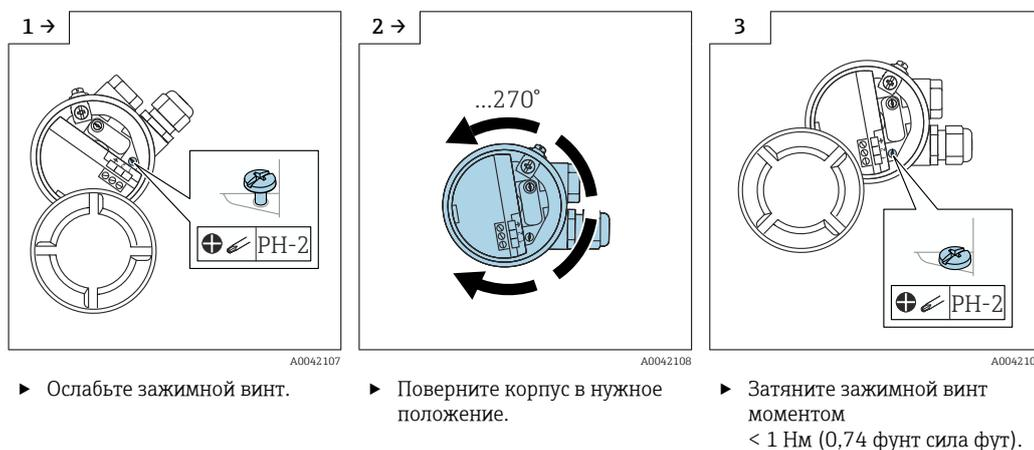
**i** Зажимной винт для выравнивания корпуса типа T13 находится в отсеке электроники.
