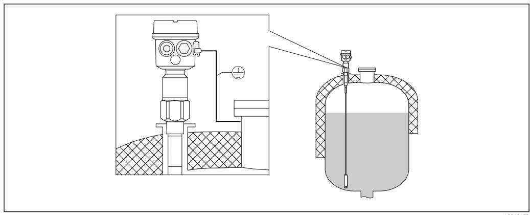
■ 4 Зонд с неактивным участком в резервуаре с теплоизоляцией
