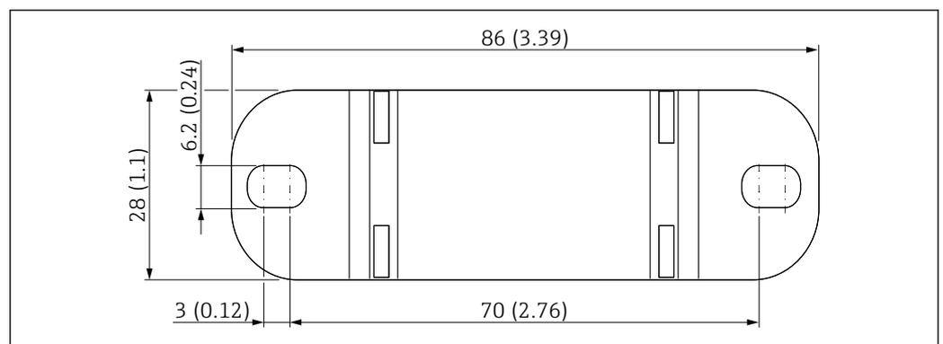
9 Обзор настенного кронштейна. Единица измерения мм (дюйм)
