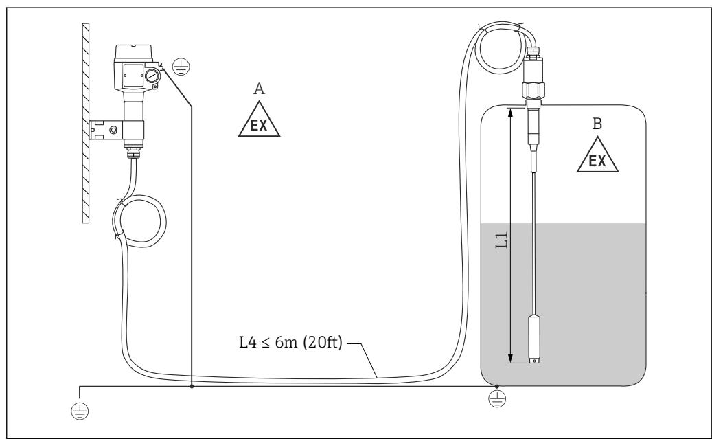
■ 7 Подключение зонда и раздельного корпуса. Единица измерения мм (дюйм)
