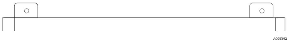
Abbildung 14. Obere Befestigungslaschen des Gehäuses
