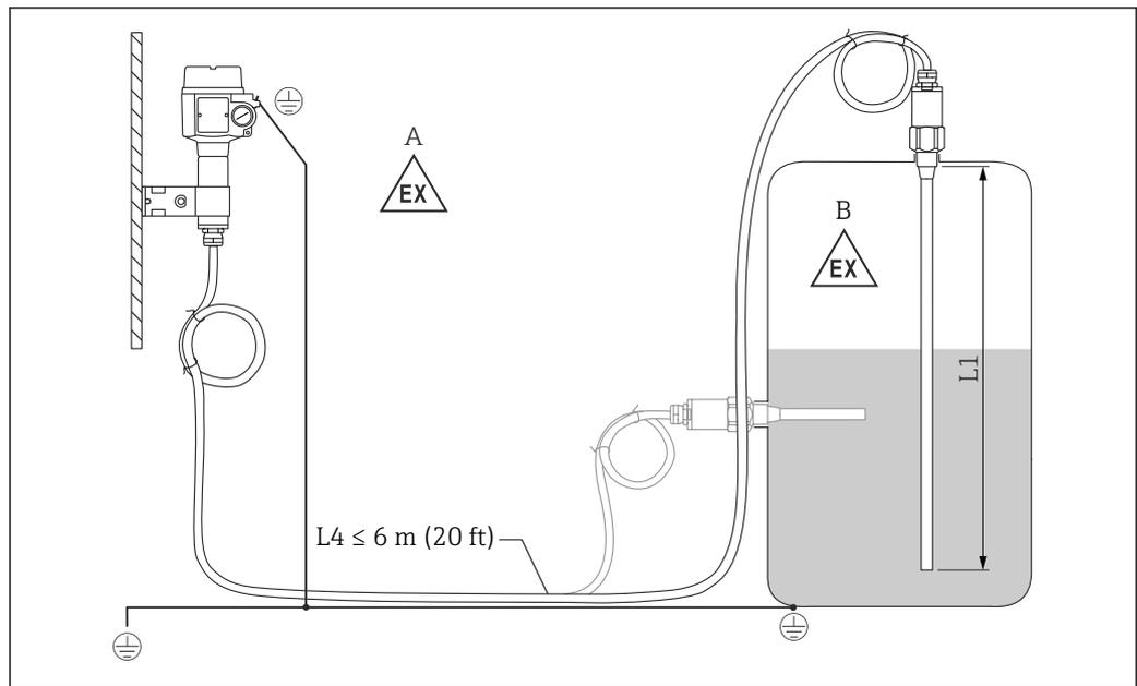
13 Anschluss der Sonde und des Separatgehäuses
