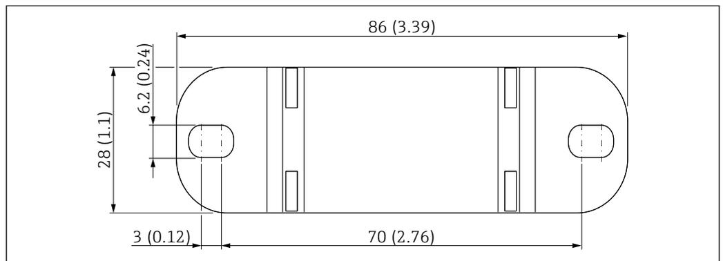
图 25 墙装架示意图。测量单位 mm (in)
