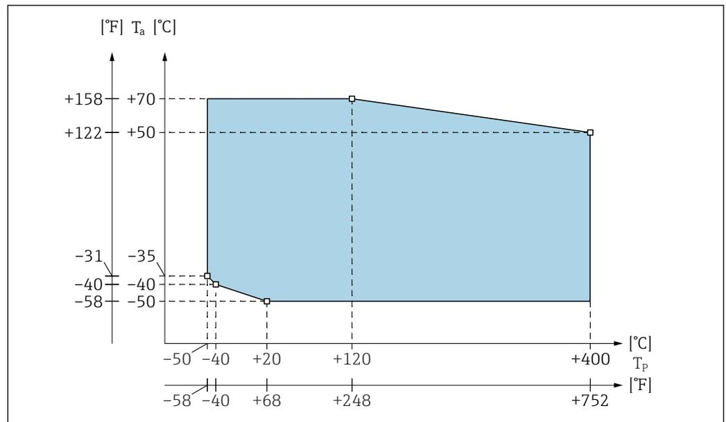
图 26 过程温度范围图：剑式和缆式探头
