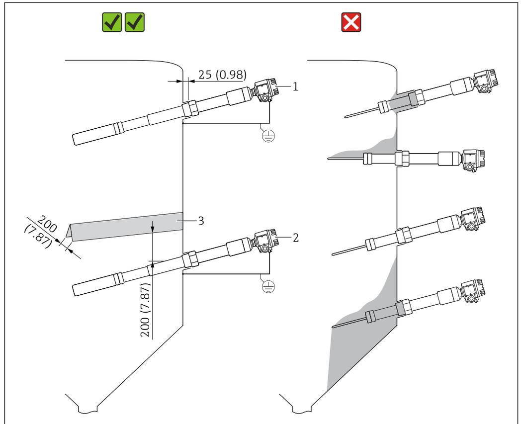
图 11 侧旁安装实例。测量单位 mm (in)
