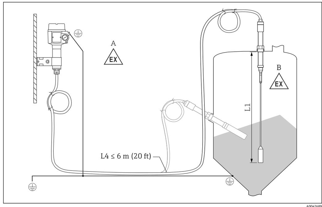
图 23 连接探头和分离型外壳
