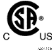
Abbildung 5. CSA-Kennzeichnung für den Einsatz in explosionsgefährdeten Bereichen in den USA und Kanada
