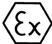
Abbildung 4. ATEX-Kennzeichnung für den Einsatz in explosionsgefährdeten Bereichen
