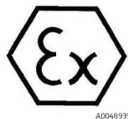
Abbildung 3. ATEX-Kennzeichnung für den Einsatz in explosionsgefährdeten Bereichen
