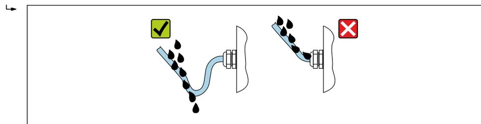
6. Die mitgelieferten Kabelverschraubungen bieten keinen Gehäuseschutz, wenn sie nicht verwendet werden. Sie müssen daher durch Blindstopfen ersetzt werden, die dem Gehäuseschutz entsprechen.
