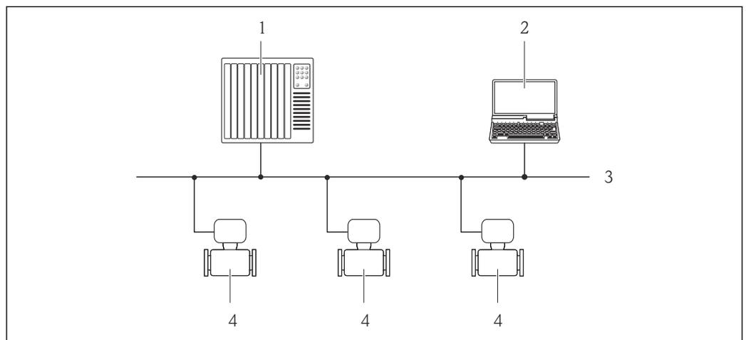
**18** Möglichkeiten der Fernbedienung via PROFIBUS DP Netzwerk
