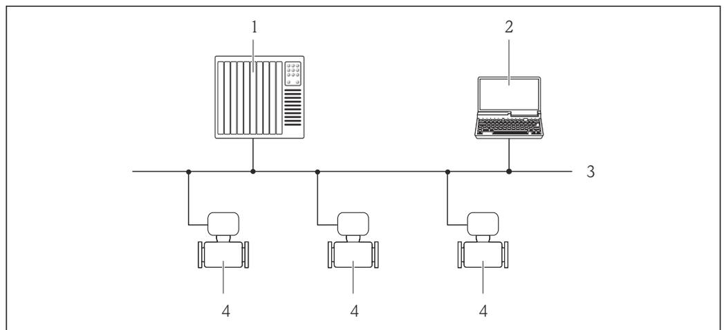
📄 14 Möglichkeiten der Fernbedienung via PROFIBUS DP Netzwerk
