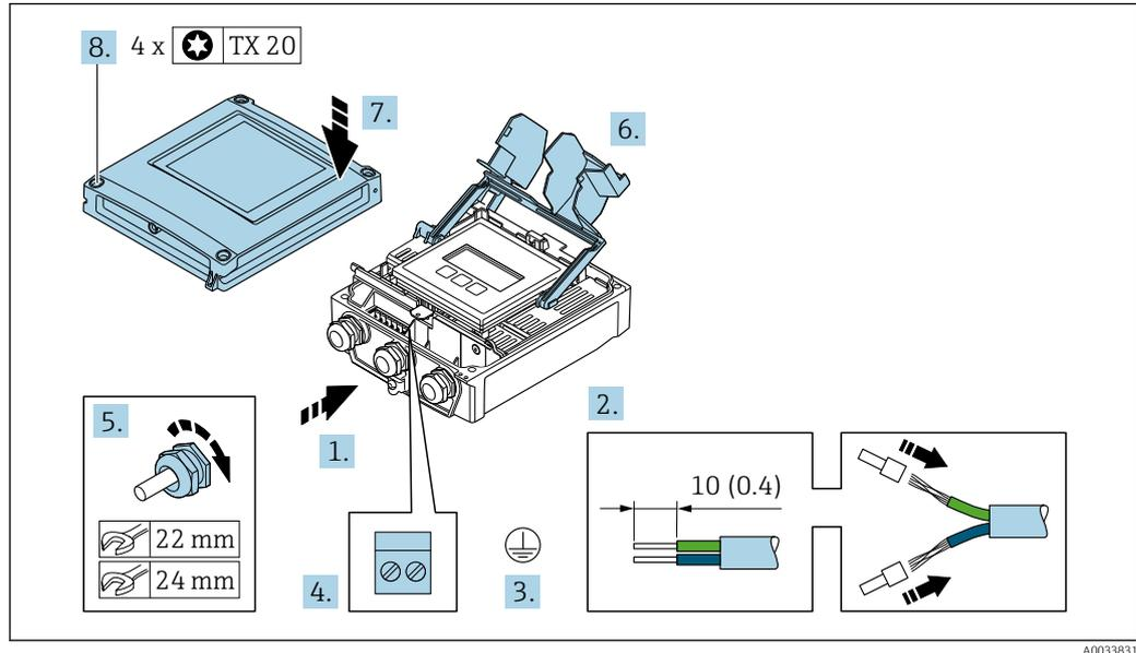
1. Kabel durch die Kabeleinführung schieben. Um die Dichtheit zu gewährleisten, Dichtungsring nicht aus der Kabeleinführung entfernen.
