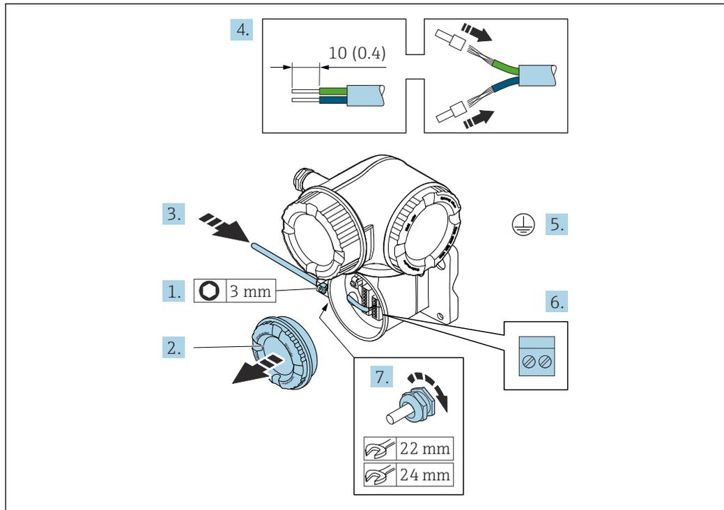
1. Sicherungskralle des Anschlussraumdeckels lösen.
