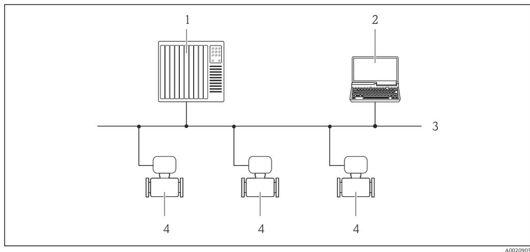
14 Möglichkeiten der Fernbedienung via PROFIBUS DP Netzwerk
